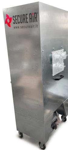
L'aspirateur sur roues pour fumées et poussières de la série DFC est conçu pour l'aspiration et la filtration des fumées et même des micropoussières très fines et volatiles générées lors des processus de traitement de surface sur les métaux ou les matériaux composites.
