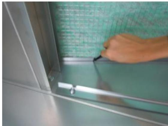
**Figura 12 - Allineamento Paint Stop**
