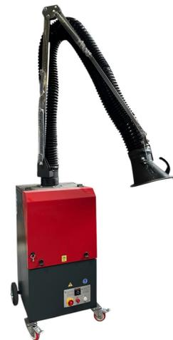
Aspiratore fumi di saldatura carrellatpcon filtrazione 99,99% @ MPPS (usato ricondizionato in garanzia)
