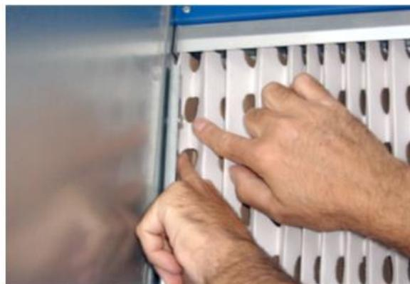
Figura 17 - Bloccaggio del filtro di carta usando i ferma-carta
