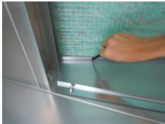
**Figura 12 - Allineamento Paint Stop**
