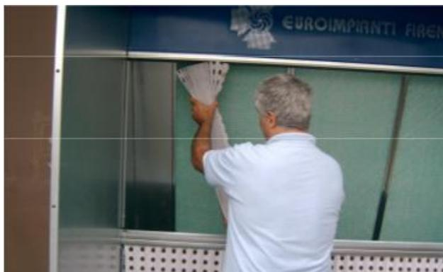
Figura 16 - Inserimento della carta all'interno delle guide
