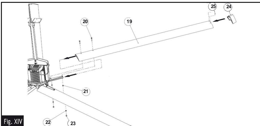
Insérez la pale (19) sur le pied de pale, bloquez-la avec les boulons à bride M8 (20), les rondelles élastiques (21) et les contre-écrous (22). Serrez les vis en vous référant au tableau 1. Montez les capuchons en plastique (23) sur les contre-écrous. Montez les cosses plates en plastique (24) à l'aide des vis appropriées (25).
