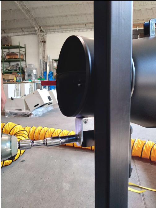
5) Stringere il bullone per il fissaggio della cappa aspirante alla piantana
