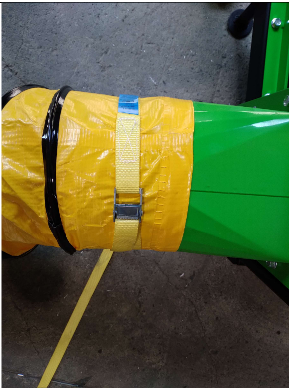
7) Montare il tubo flessibile con la fascetta stringitubo sulla bocca premente
