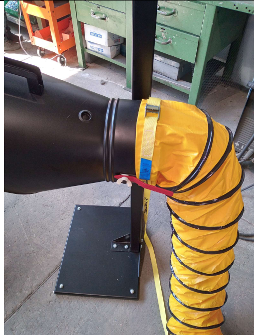
6) Montare il tubo flessibile con la fascetta stringitubo sulla cappa aspirante
