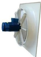
Nel caso di montaggio con asse orizzontale di un ventilatore con convogliatore ad alto profilo sia in configurazione aspirante (Q) che premente (H), prevedere opportune strutture di sostegno per il motore, in quanto il peso potrebbe deformare il convogliatore andando ad alterare il gap minimo necessario (vedi 4.4).
