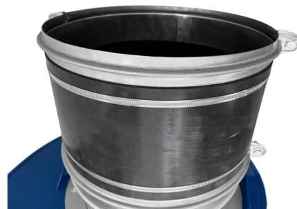
Giunto antivibrante circolare **per fissaggio su raccordo di mandata ventilatore**, realizzato con gomma telata industriale, completo di bordatura predisposta e collari di fissaggio.
