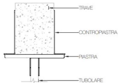
Kit di fissaggio per ventilatori SMHS in versione HVLS compatibile con travi a sezione rettangolare con base compresa tra 100mm e 260mm.
