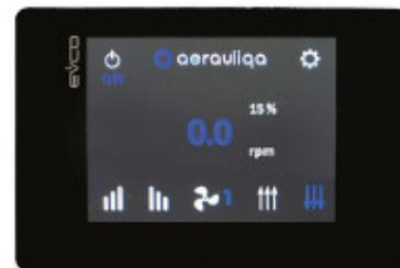
Pannello di controllo touch da 3,5” con display grafico a colori che può controllare fino a 4 unità.
