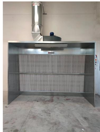
Le **cabine di verniciatura WFPN** sono dotate filtrazione a secco ed aspiratore integrati e grazie alla loro geometria formano un fronte aspirante a velocità costante in modo da captare gli inquinanti prodotti da operazioni come la verniciatura, la resinatura, gli incollaggi e in tutti quei trattamenti professionali che generano overspray di applicazione.
