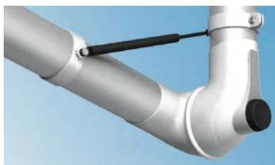
I bracci diam 75 di lunghezza 1,5 e 2 m sono forniti con pistone a gas per una migliore stabilità. Il pistone a gas può essere usato come finecorsa in altezza, ad esempio in caso di lampade.
