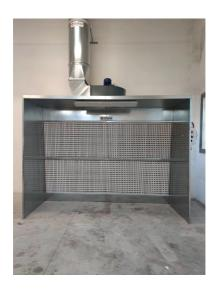
Exemple d'installation d'une cabine de pulvérisation avec extensions et toit, avec éclairage et panneau de commande.
