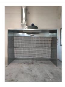
Les cabines de pulvérisation WFPN sont équipées d'une filtration sèche et d'une aspiration intégrées et, grâce à leur géométrie, forment un front d'aspiration à vitesse constante pour capturer les polluants produits par des opérations telles que la peinture, le revêtement de résine, le collage et tous les traitements professionnels qui génèrent une surpulvérisation de l'application.
